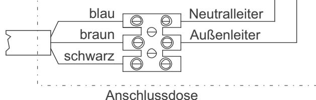
Wird der schwarze Leiter nicht verwendet, ist er an eine elektrisch isolierte Klemme anzuschließen und nicht an das Stromnetz.
