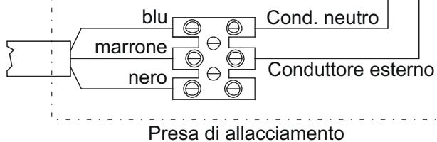
Qualora si decida di non utilizzare il conduttore nero, è necessario collegarlo a un morsetto isolato elettricamente e non alla rete elettrica.
