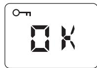
Wurde der Code korrekt eingegeben, blinkt OK und das Symbol  $\text{OPEN}$  erlischt.
