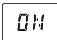
Tasten  $\text{Mode}$  und  $\text{Boost}$  gleichzeitig 3 s lang drücken, um das Programmiermenü zu öffnen.
