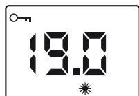
Taste  $\oplus$  und  $\ominus$  gleichzeitig 3 s lang drücken, bis CLEF 1 und das Symbol  $\text{OPEN}$  angezeigt werden.
